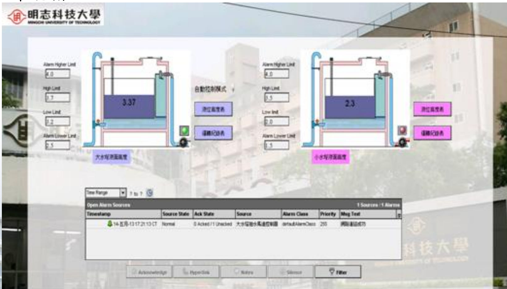
智能供水系統智能液位監控系統
