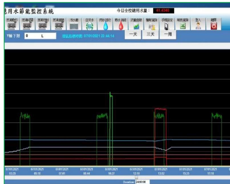
流量曲線圖：找漏水最佳工具
