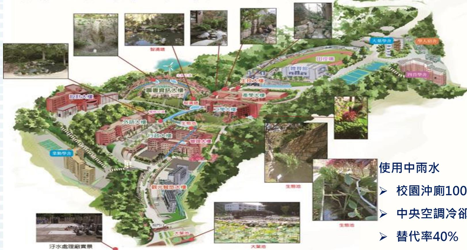
依校園特色多元開發替代水源，包含中水回收、雨水及山泉水，應用於沖廁、澆灌、冷卻及生態池，減少自來水用量。
